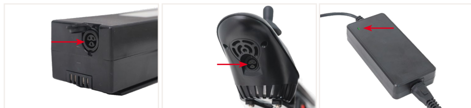
Abbildung 9: Die Anschlüsse für das Ladegerät und Anzeige am Ladegerät
